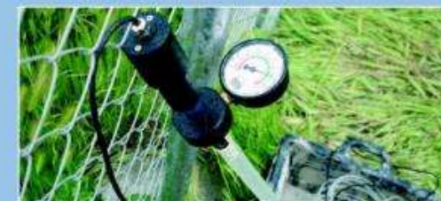
Detalle del medidor que posee el tensiómetro.
