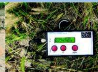
Instrumento que, conectado al humidímetro, nos informa sobre la permitividad y la temperatura de la ZNS.
